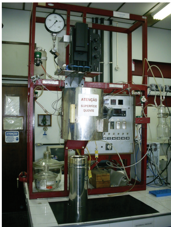
Figura 2. Foto da Unidade MAT utilizada nos testes de co-pirólise de polipropileno e gasóleo (próprio autor).
